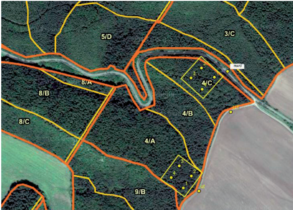
1. ábra. Két mintavételi terület és a részminták elhelyezkedése a Penc 4/A és 4/C részletekben, NÉBIH Erdőtérképen feltüntetve. A terepen a részminták középpontjait jelöljük meg és mérjük be GPS-szel
